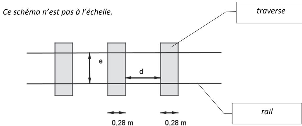
2. On considère à présent une traverse en bois de chêne sec utilisée pour une voie de chemin de fer. Elle est modélisée par un pavé droit de 2,60 m de longueur, 28 cm de largeur et 14 cm d'épaisseur. La densité du chêne sec est de  $690 \text{ kg/m}^3$ .
