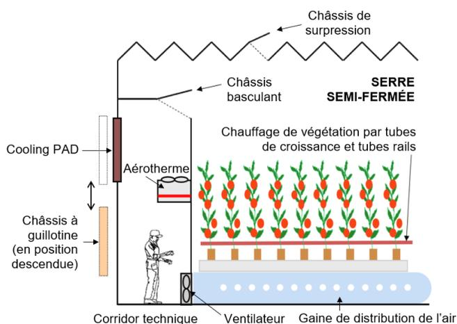
Ce système comprend un corridor technique, couloir occupant toute la longueur de la serre et permettant les opérations suivantes :
