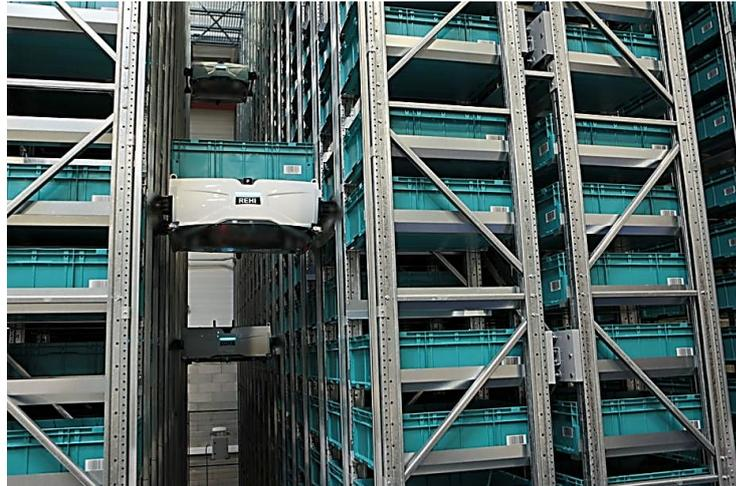
Figure 8 : déplacement vertical du robot entre les étagères
