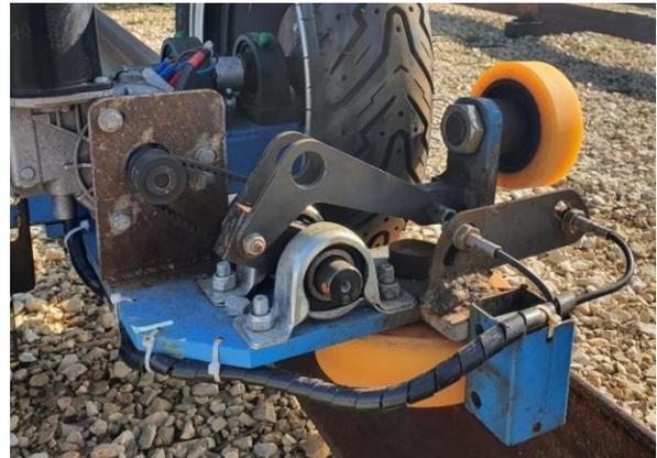
Figure 20 – Position basse et haute du galet
