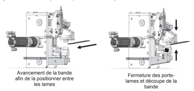
Figure 2 : Cycle de fonctionnement (étapes 1, 2 et 3)
