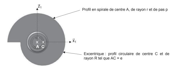
Figure 4 : Géométrie de l'arbre à cames (en position  $\alpha = 0^{\circ}$ ,  $\vec{x}_1 = \vec{x}_2$ )
