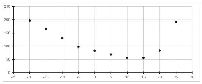
Figure 14 : Effort du vérin en Newton en fonction de l'angle du levier en degré par rapport à l'horizontale
