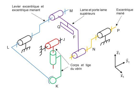
Annexe H - Schéma cinématique et paramétrage associé pour le mécanisme de coupe en position initiale
