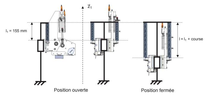
Figure 12 : Ensemble porte-lame / ressorts de rappel (le levier supérieur et la bande à découper ne sont pas représentés)
