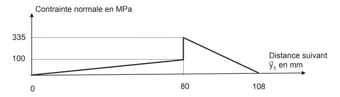
Figure 18 : Contrainte normale en MPa dans la fibre inférieure
