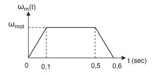
Figure 13: Profil de vitesse du servomoteur
