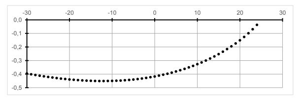
Figure 11 : Déplacement latéral en mm du point F en fonction de l'angle du levier en degré par rapport à l'horizontal
