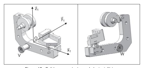
Figure 15 : Solides en contact avec le levier inférieur
