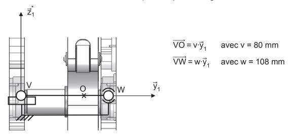
Figure 17 : Schéma cinématique et paramétrage associé de la liaison entre l'axe du levier inférieur et le bâti
