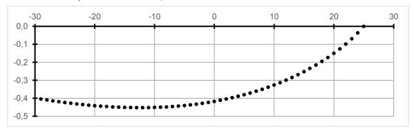
Figure 10 : Déplacement latéral en mm du point Q en fonction de l'angle du levier en degré par rapport à l'horizontal
