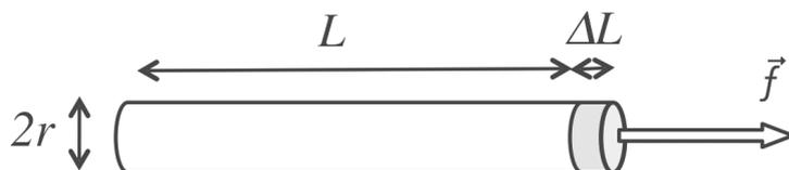
FIGURE 9 – Modèle de tige élastique de longueur  $L$ , rayon  $r$ , soumis à une force  $\vec{f}$  qui induit un allongement  $\Delta L$ .
