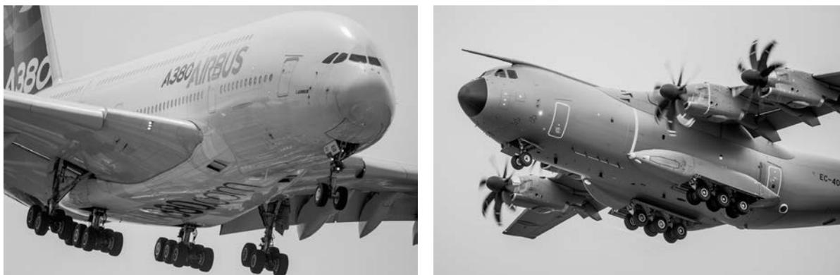
FIGURE 1 – Airbus A380 avec ses 5 trains d'atterrissage comportant 22 roues (un à 2 roues, deux à 4 roues, deux à 6 roues), et Airbus A400M avec ses 3 trains d'atterrissage comportant 14 roues (un à 2 roues, deux à 6 roues) : deux solutions techniques pour deux ensembles d'exigences différents
