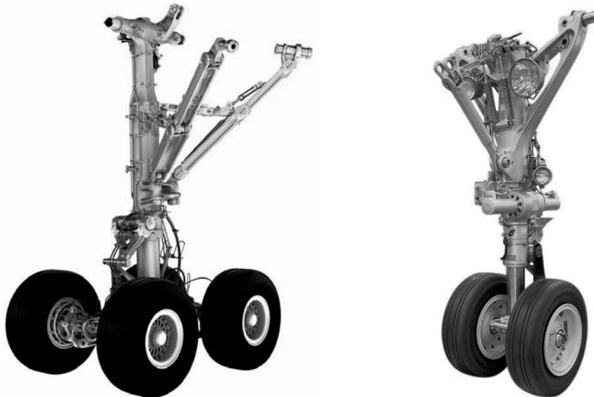
FIGURE 2 – Gamme de trains d'atterrissage Safran Landing System
