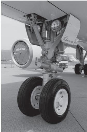
FIGURE 4 – Train d'atterrissage avant Safran d'un Airbus A319, avec sa porte ouverte
