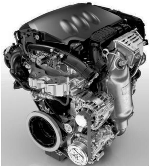
Ce moteur développé par PSA fait partie de la famille EB des moteurs 3 cylindres. Après 4 ans de développement et 121 brevets déposés, il a été lancé courant 2012 en version atmosphérique 1L et 1,2L sur la Peugeot 208. Il équipe depuis début 2014 les versions turbo 1,2 L 110 et 130 chevaux des Citroën C3, C4, DS3, et des Peugeot 208 et 308.
