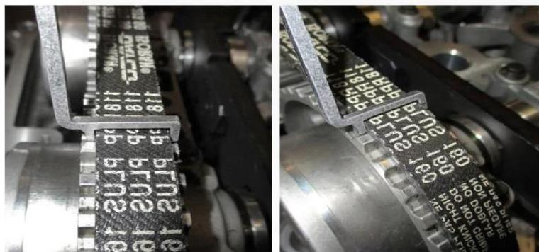
La largeur de la courroie doit être vérifiée.
