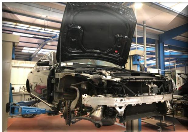
Éléments déposés, déformation pied de caisse avant droit.
