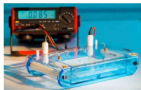
Figure 3 – Dispositif pour électrophorèse sur gel. Source : Wladimir Bulgar, <https://ndla.no/image/53118>.
