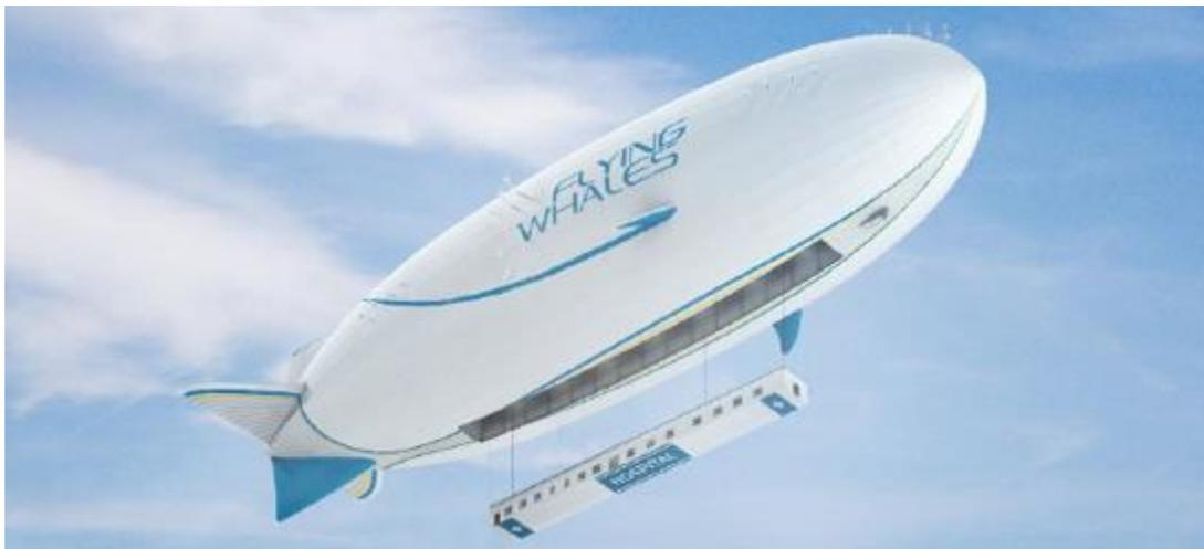
Ce système hors norme (200 m de long, 60 tonnes de charge utile, 4 MW) était le support de cinq parties abordant l'ensemble des domaines de l'ingénierie électrique (automatique, informatique appliquée, électronique, conversion d'énergie) :
