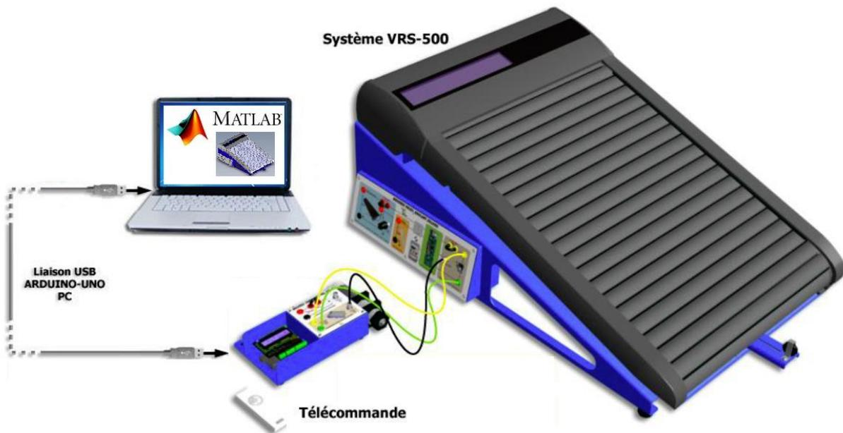
Mettre le volet en position « totalement ouvert ». Après avoir réalisé le câblage du sous-système, comme indiqué sur la figure précédente, ouvrir le modèle Matlab disponible dans le dossier « Fichiers Matlab/Virtual VRS-500 » par le fichier « VRS\_S\_model.mdl » et faire vérifier votre montage par votre examinateur.
