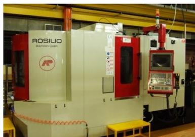
✓ **Un centre d'usinage 5 axes vertical : (CN SIEMENS 840D)**
