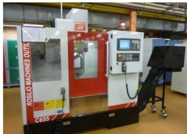
✓ **Un centre d'usinage 3 axes vertical : (CN HEIDENHAIN ITNC530)**
