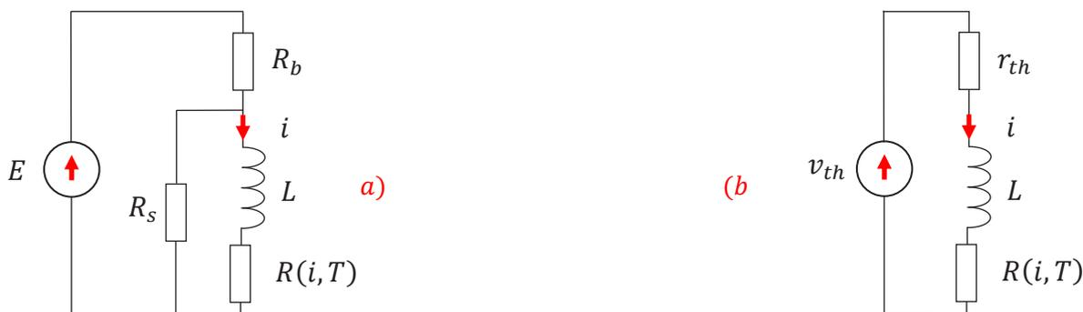
**Figure 8** modèle électrique du bolomètre
