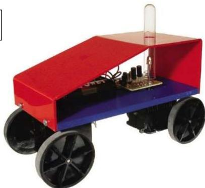
Véhicule 4 roues motrices. 2 moteurs alimentés en commun par les mêmes piles.
