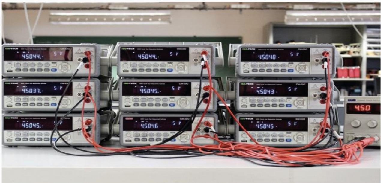
FIGURE 5 – Plusieurs voltmètres de la même référence sont branchés en parallèle sur une source de tension. Ils n'affichent pas la même valeur.
