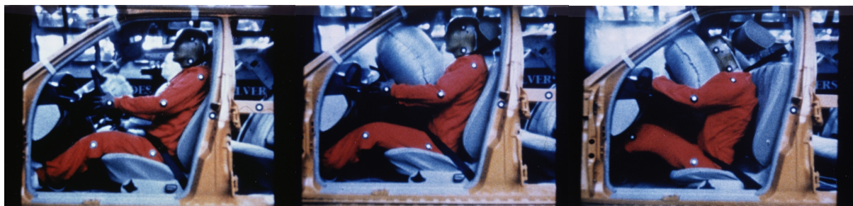
Chronophotographies du déploiement d'un airbag lors d'un test de collision [c] .
