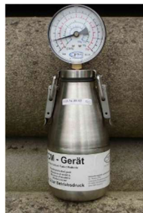
Figure 7 : Test à la bombe au carbure : ce test permet de déterminer le taux d'humidité précis dans les matériaux pour le bâtiment. Source : https://www.deltacontrole.be/
