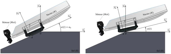
Figure 10 - Paramétrage du navire durant la phase de rétablissement
