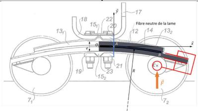
La figure ci-dessus a pour vocation d'illustrer le modèle retenu pour l'étude de la lame de suspension. Du fait de la fixation rigide de la lame sur la traverse, on peut se limiter à l'étude d'une demi-lame.
