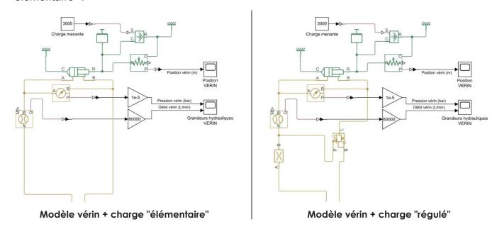
Pour les deux modélisations présentées ci-dessus, la partie du circuit hydraulique qui correspond à la génération et à la distribution de puissance hydraulique est identique. La loi de déplacement imposée au tiroir du distributeur correspond à un cycle complet de déploiement et d'escamotage de l'IMS.
