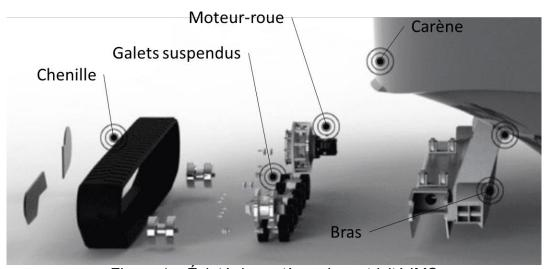
Figure 4 – Éclaté du système de motricité IMS
