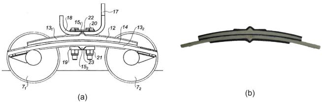
Figure 12 – Schéma de principe issu du brevet FR3054487 (a) Lame réelle utilisée sur l'IMS (b)
