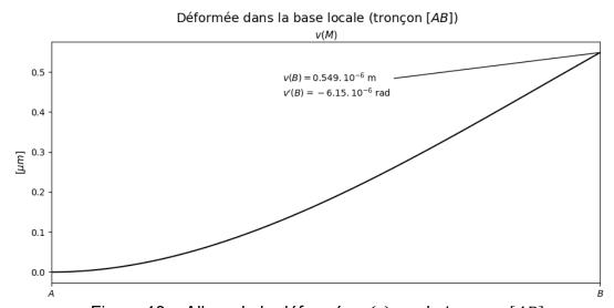
Figure 13 – Allure de la déformée v(s) sur le tronçon [AB]
