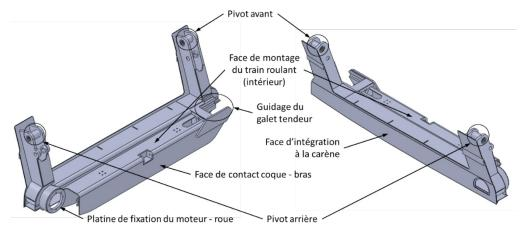
Figure 14 – Vue isométrique sous deux angles du bras tribord
