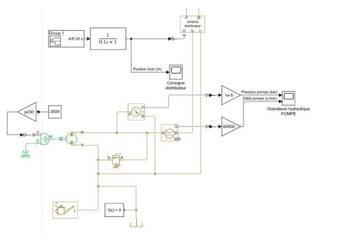
Modèle du groupe électrohydraulique + distributeur
