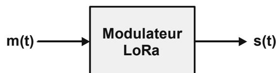
Le signal  $s(t)$  est un signal sinusoïdal modulé en fréquence dont la fréquence évolue linéairement au cours du temps (signal que l'on désigne par le terme *chirp*).
