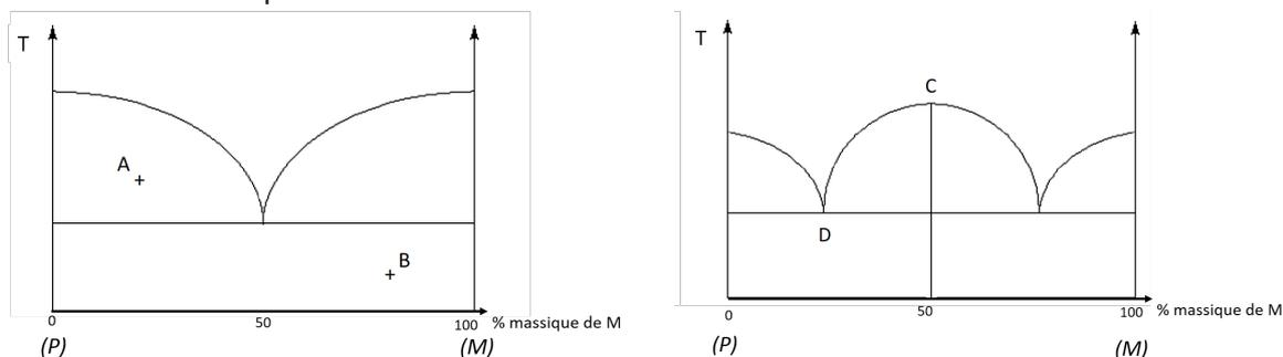
**Figure 2.** Diagrammes binaires liquide-solide de type conglomérat (gauche) et de type racémique (droite).
