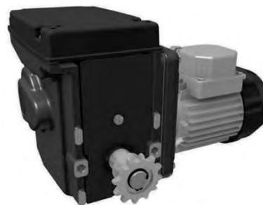
Tous les motoréducteurs RW45 sont réalisés avec un set de vis sans fin autobloquant. Cette transmission assure le freinage de l'arbre d'entraînement quand l'entraînement est arrêté. La combinaison de transmissions à pignons et à denture hélicoïdale assorties produit une transmission mécanique très silencieuse.
