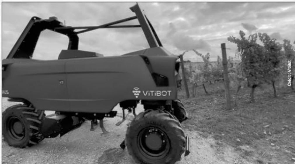
Avec ses interceps mécaniques et sa gyro-tondeuse, le robot de VitiBot se positionne comme un véritable allier du travail du sol.
