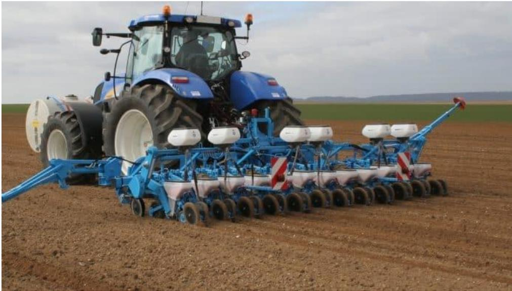
Le logiciel à bord du tracteur utilise les données satellites de la parcelle et le système GPS pour distribuer de façon différentielle les engrais.
