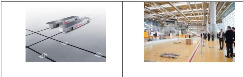
**Composé de deux modules se déplaçant simultanément, le robot industriel d'Eisenmann ressemble à un transpalette industriel classique, le manche directionnel en moins.**
