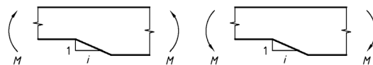
Figure 6.10 - Flexion au niveau d'une entaille. A gauche, contrainte de traction du côté de l'entaille, à droite contrainte de compression du côté de l'entaille
