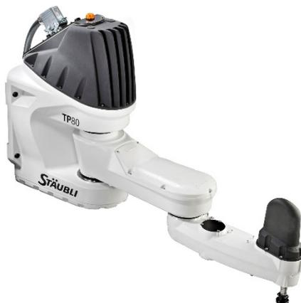
Robot 4 axes dit « à plans parallèles »
