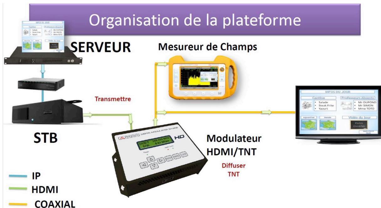
A ce stade, dans l'hôtel, le signal hertzien serait transmis à une antenne de diffusion, mais nous nous limiterons pour cette épreuve, à transmettre ce signal directement sur l'entrée coaxiale d'un téléviseur (voir synoptique de la page 6). Précisons enfin que pour cette expérimentation, nous diffuserons sur cette chaîne locale, en lieu et place de la vidéo informationnelle, la vidéo Big Buck préenregistrée sur le serveur.
